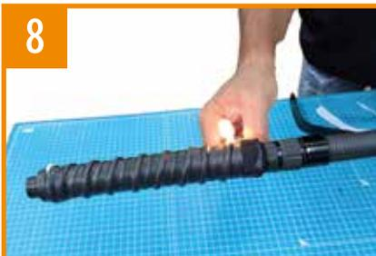
収縮チューブをライターやドライヤー等で回転させながら均一に加熱収縮させます。
