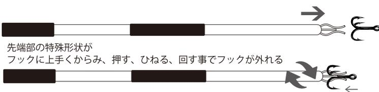
大型魚(クロマグロなど)をリリースする際、フックを外す前に魚の力を抑え込む必要がある。その為に開発されたのがソウルズギャフ(ギャフ偉知郎)。魚にダメージを与え、刺すのではなく安全にかつ、魚に優しくリリースする為のギャフである。ギャフの先端が外向きになっているという他にはない形状。魚に最も負担の掛からない下顎(血が出にくい箇所)にスムーズに掛ける事が出来るよう設計した。この形状により船から魚が少し離れた状態でも容易にフックを掛けることを可能にした。必ずしも、キャッチ時に魚が横になって水面上がってくるとは限らない。垂直に、まるでロケットのように浮いてくる時もある。通常のギャフであれば、まっすぐ上にギャフを引いても掛かりづらい事が多い。ソウルズギャフはギャフは、先端が外向形状であることで、どんな状態の魚にもスムーズにギャフを掛ける事が出来る。ソウルズリリーサー(イチロー棒) ソウルズギャフ(ギャフ偉知郎) この二つの組み合わせにより魚にダメージを与える事無く安全に大型魚のリリースを可能とした。
