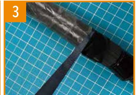
保護フィルムを剥がし、グリップテープの先端の三角部分にある紙を剥がして図のように斜めになっている部分をグリップ部分の端にあて、巻いていきます。
