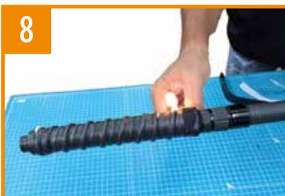
収縮チューブをライターやドライヤー等で回転させながら均一に加熱収縮させます。
